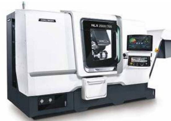
Le deuxième tour DMG est arrivé ! Nous avons donc doublé notre capacité de production de pièces tournées en CN. Nous pouvons usiner des barres de décolletage jusqu'à Ø80 mm. Ce tour est muni d'un embarreur IEMCA, qui permet de réduire les temps de chargement de matière première. Pour gagner en rapidité de montage et en efficacité, nous programmons tous nos tours avec le logiciel ESPRIT.
