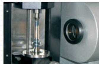
et en quelques secondes, nous avons les mesures de toutes les caractéristiques à quelques microns près. Grâce à un procédé de rotation, la machine mesure également les défauts de formes diverses comme les concentricités ou les circularités.
